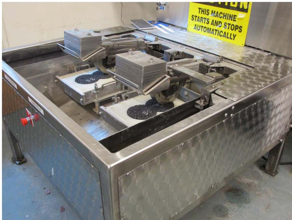
**Figure 2.15: Hamburg Wheel-Track Tester.**
